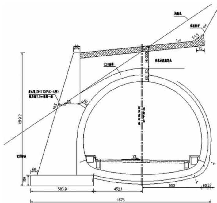
图2 浅埋偏压大断面隧道洞口施工技术
