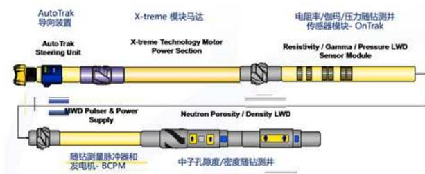
图 2 随钻旋转导向系统井下设备组合示意图
