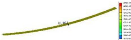
图 4.4-4 单辆 80t 挂车作用下主索索力图（单位：KN）
