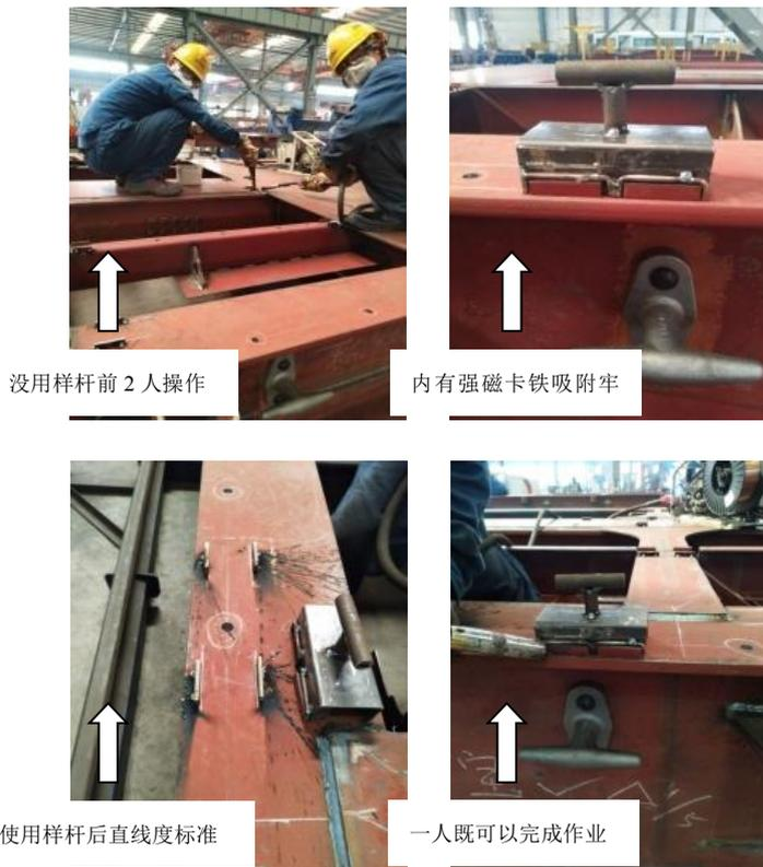
图 1 卡铁组对样杆示意图
