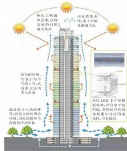
图1 某低碳建筑的体型及结构设计示意图
