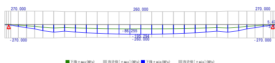
图 5 工字型钢主梁下缘弯曲正应力包络图
