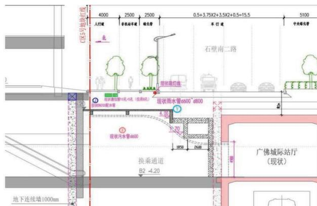
(图2 项目小基坑现状管线图)
