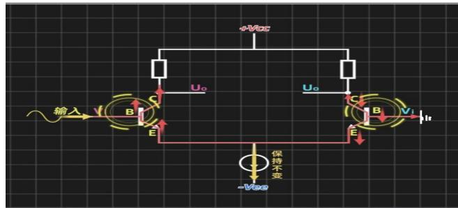
首先要说明的是，两路共射电路的公共部分并非简单的发射极连接，而是拖着一个长长的尾巴，戏称“长尾”，尾巴需要有阻抗无限大的元器件组成，因为这很难实现，所以又引入了恒流源，恒流源的另一头是要加负电源的。恒流源工作原理不赘述，它的作用则是保证流入的电路不变，根据基尔霍夫电流定律，节点电流为0，当向下方向的电流不变的时候，动态产生的电路左边的电流( $\Delta i$ )会完全流到右边去。左边从发射极流下来的电流 $I_e$ 系由输入信号引起，接近于正比 $U_i$ ；右边得到了流过来的 $I_e$ ，其大小与左边相同，方向则相反，根据共射放大电路的特点以及两边电路的对称性，右边的 $I_e$ 也会正比于一个 $-U_i$ ，实际上就起到了从左边端口输入 $-U_i$ 的效果。 $U_i$ 和 $-U_i$ ，正好就是一对大小相同、方向相反的信号。按照定义，这个就是差模信号。所以，得出了“有用的信号成为一对差模信号进入输入”的结论。
