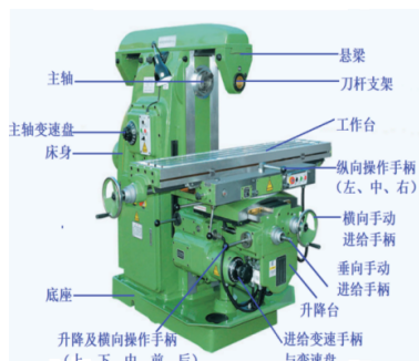
图2 X62W 实际铣床外形及结构
