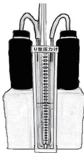
图 2-5 基于 U 型压力计的“黑黑”式热辐射计
