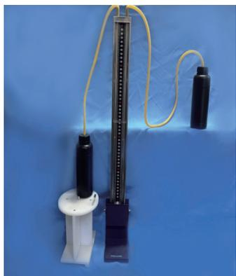
图 2-6 基于 U 型压力计的热辐射计
