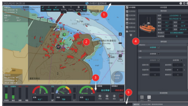
图 3-3 无人船显控软件界面示意图
