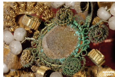
图4 1740年左右, 特格森修道院圣基里努斯教区圣基里诺和科尔比尼安圣骨匣玻璃圆形凸起造成的腐蚀, 编号83W17632。
