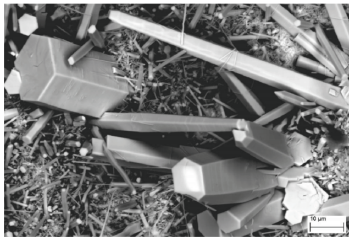
图1 在 \text{Na}_2\text{CO}_3 溶液中铝箔上生长的六角 \text{NaPb}_2(\text{CO}_3)_2(\text{OH}) 晶体的FE-SEM BSE图像(照片: Dirk Kirchner)。
