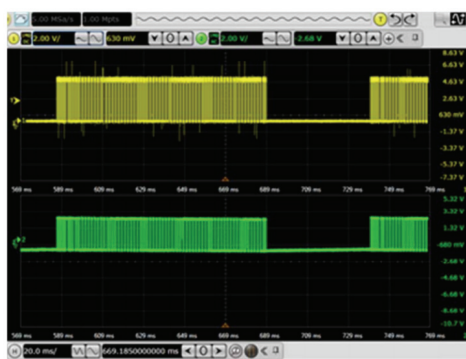
图 12 发射和接收基带波形
