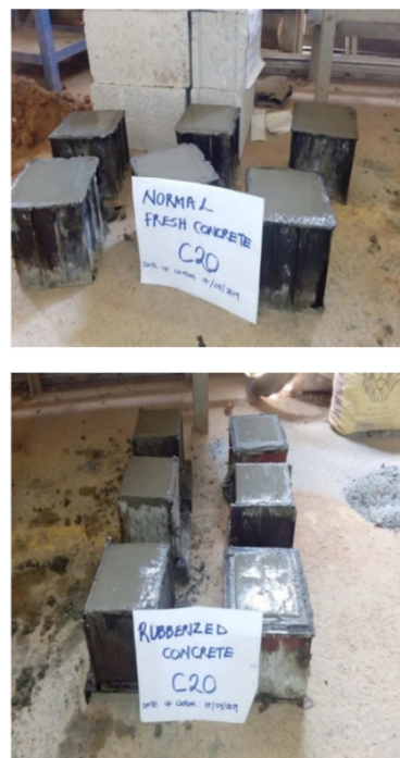
图 3. 控制混凝土和橡胶混凝土试件的浇筑。
