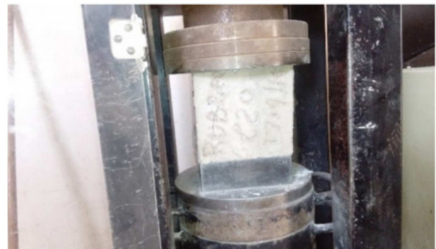
图 8. 橡胶钢筋混凝土和普通混凝土在 100℃ 下加热 48 小时后出现一些裂缝。
