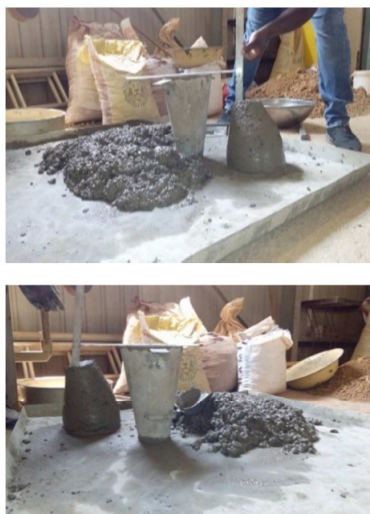
图 2. 普通混凝土和橡胶混凝土的坍落度。
