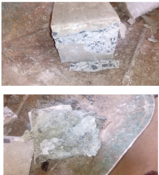
图 10. 受压后加热橡胶钢筋混凝土和普通混凝土的破坏模式。
