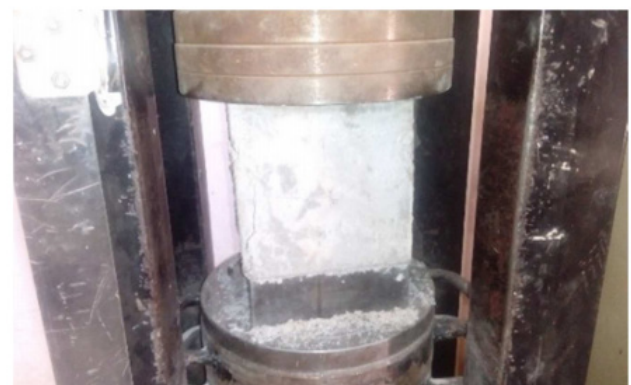
图 9. 加热橡胶钢筋混凝土的压缩试验。
