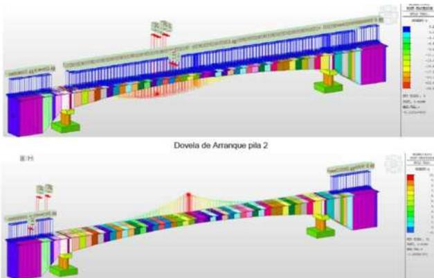
图3 Midas 建模分析变形量
