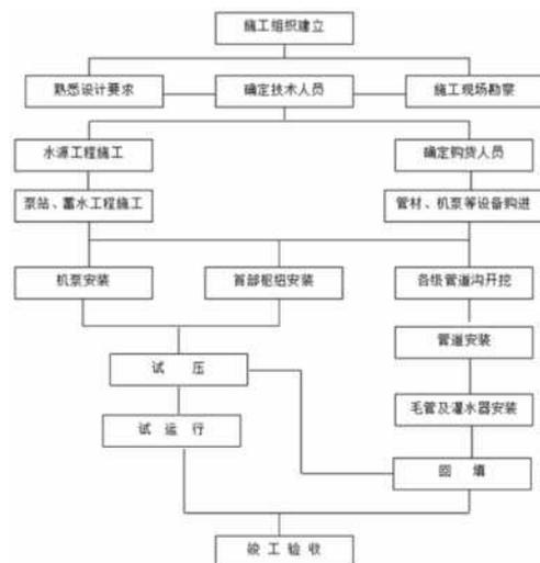
图1 水利工程施工的过程
