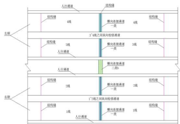
图1 梁式渡槽连接通道布置图
