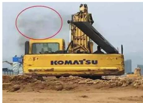
图3 机械排出废气
