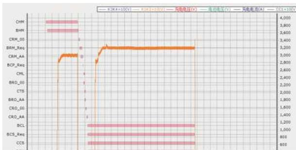
图5 输出电压纹波异常
