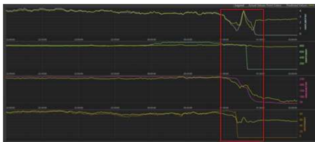
图5(a) 磨煤机异常工况下的预测数据与真实数据变化曲线
