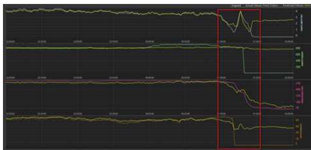
图5(b) 磨煤机异常工况下的预测数据与真实数据误差变化曲线
