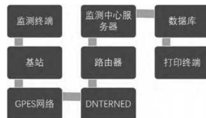
图3 机电一体化的监控体系图
