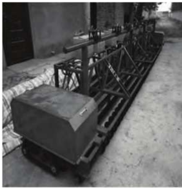
图2 四轴摊铺机示意图
