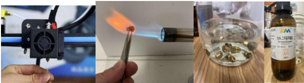
(a) 机械清理 (b) 热烧法清理 (c) 化学清理
