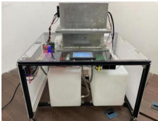
图 7 FDM 型 3D 打印机喷嘴清理系统
