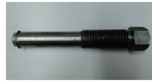
2-3 闭锁螺栓端部损坏图
