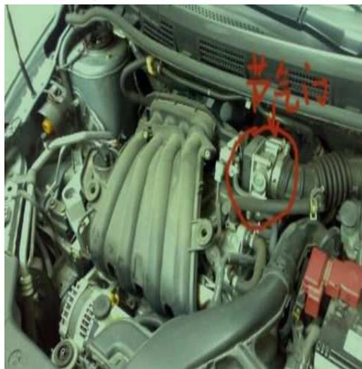
图 2 发动机节气门
