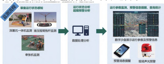
图3 施工装备状态监测流程图示
