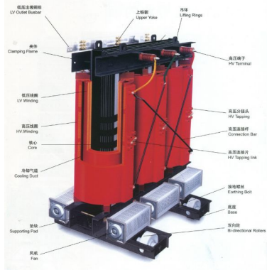
图 1 变压器结构图
