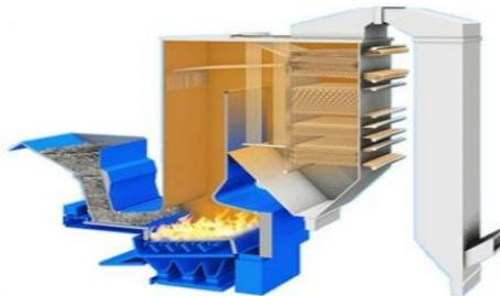
图 5 炉排炉展示图
