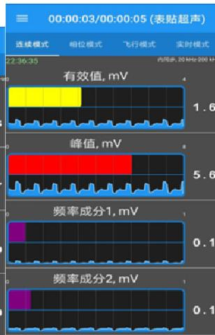
图 3 50522 隔离开关 A 相气室图谱
