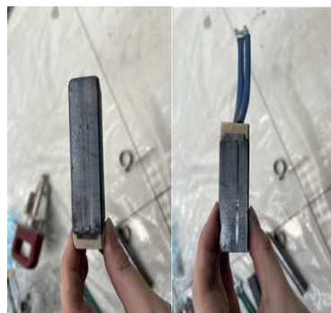
图 2 发电机碳刷卡涩磨痕
