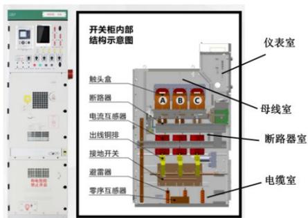
图 1 纵旋柜结构示意图
