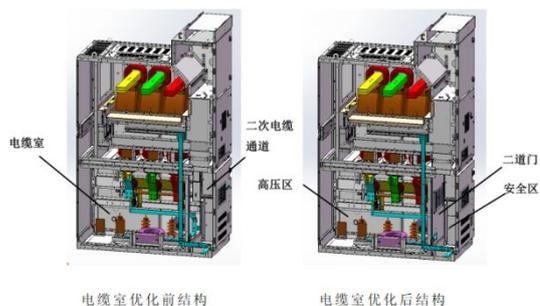
图6 纵旋柜电缆室结构
