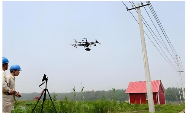
图1: 无人机技术在电力线路中的巡检应用
