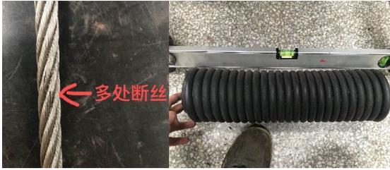
图 3 钢丝绳断丝、钢弹簧弯曲变形
