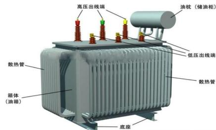
图 3 变压器构成图
