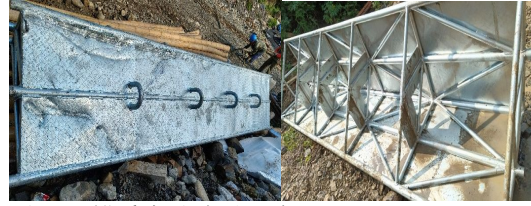
图 9 地锚受力试验后照片
