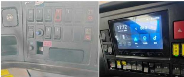
(a) 未改造前的带电清洗车的中控台 (b) 改造后的带电清洗车中控台
