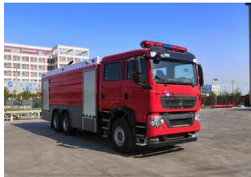
图 1 RT5320GXFSG120/H6 水罐消防车
