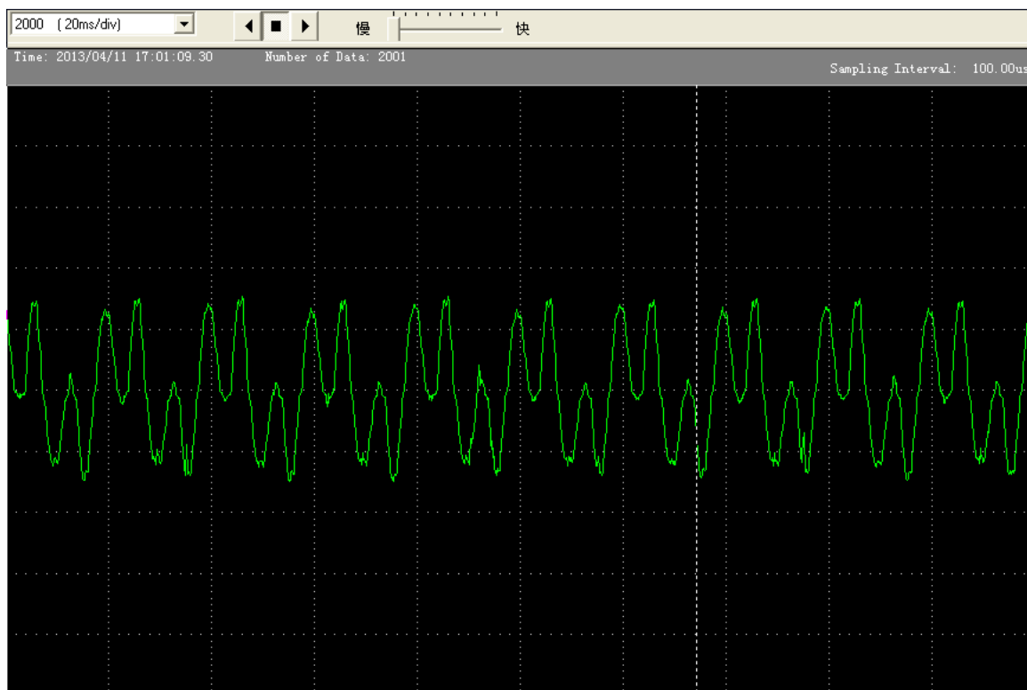
图 2 模拟发电机 8 瓦轴接地时电流波形
