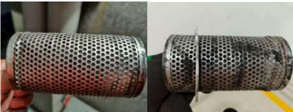
图 4 2A、2B 给泵密封水拆出滤网
