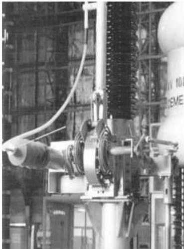
图3 AREVA STB+CK型接地开关配用的SF6灭弧室
