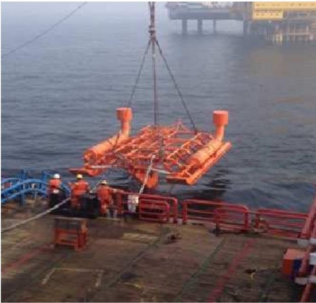
图2 埋缆机海试结束出水
