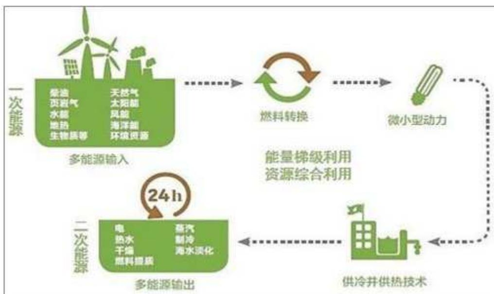
天然气分布式能源给出了明确定义,天然气分布式能源是指利用天然气为燃料,通过冷热电三联供等方式实现能源的梯级利用,综合能源利用效率在70%以上,并在负荷中心就近实现能源供应的现代能源供应方式,是天然气高效利用的重要方式。天然气分布式能源节能减排效果明显,可以优化天然气利用,并能发挥对电网和天然气管网的双重削峰填谷作用,增加能源供应可靠性、安全性。
