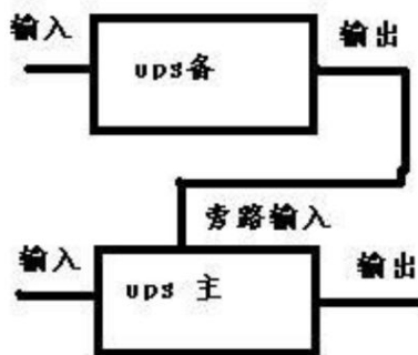
图1 数据中心串联供电方案图示
