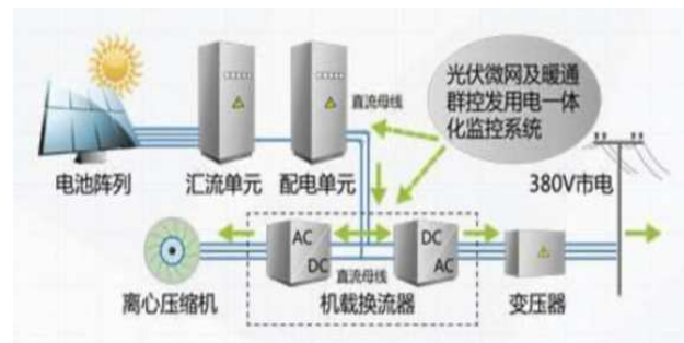
图2 光伏+空调发电系统
