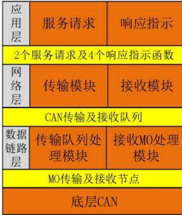
图2 EPS系统软件架构图
