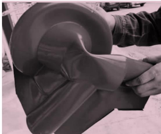
图 1 三元乙丙橡胶绝缘材料拉伸
