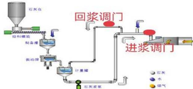
图2 石灰浆制备系统原理图
