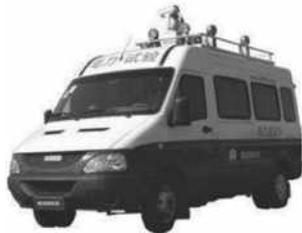
图1 高压程控电气试验车
