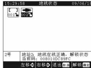
图3 地线管理器显示地线状态的界面
