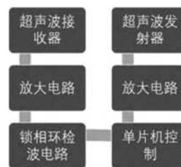
图1 机电一体化信号运输流程
