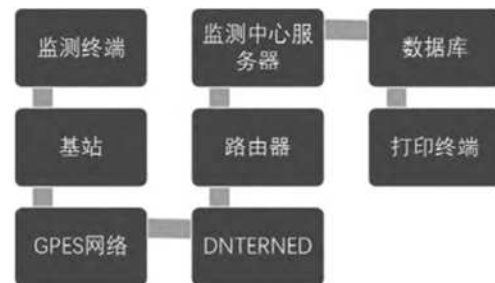
图3 机电一体化监控体系图
