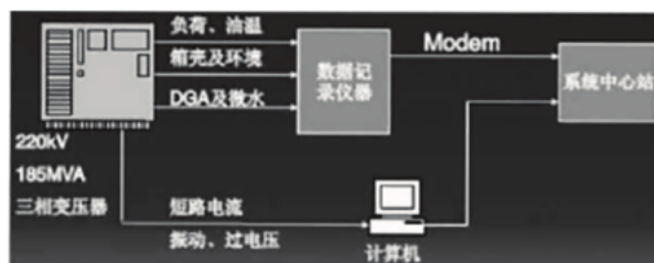
图1 变压器在线监测系统框图
