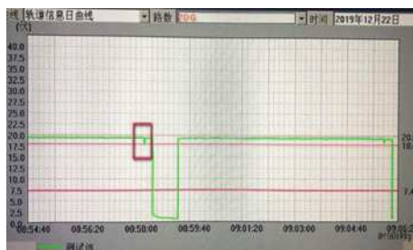
轨道电路日曲线异常波动曲线
