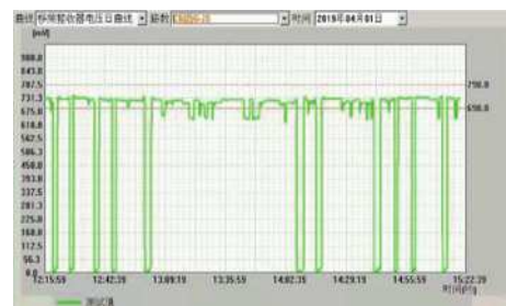
移频接收器电压异常曲线
