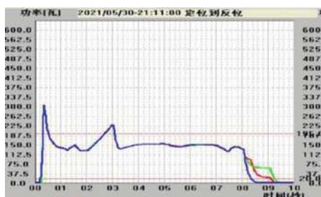
道岔转换过程中卡阻曲线
